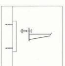
Dirsek kolları T 40 üzerinde T somun ile birlikte yüksekliği ayarlanabilir. Cantilever arm is used with T bolt for adjusting the height.
