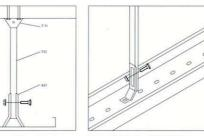
A 21 çiftli kullanılabildiği gibi tekli kullanılarakta kablo kanalı askılanabilir. Can be used both even or add.
