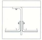
Duvara monte edilmiş T 32 Askı Rayı üzerine T somun kullanarak H 50 montaj edilebilir. Can be mounted to the pendant rail.
