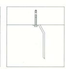
A 21 çelik dübel kullanılarak beton duvara montaj edilebilir. Can be mounted on the wall.
