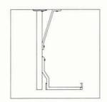
Ağır yüklerde T 2 üzerindeki sehimi azaltmak A 1 Askı Barası kullanılır. It is used in heavy duty trays.
