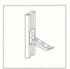
Montaj Rayı T 40, dirsek kolu H 50 ve H 70 ile tuğla duvar arasında kullanılarak duvardaki basıncı azaltır. Ayrıca dirsek kolunun dikeyde hareketini sağlar. This piece is used for reducing
