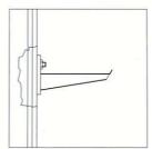
Duvara monte edilmiş T 32 Askı Rayı üzerine T somun kullanarak H 50 montaj edilebilir. Can be mounted to the pendant
