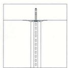
Dik Parça T 2 beton duvara çelik dübel ile montaj edilebilir.
