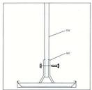
Kablo kanalları destek braketi A 1940, T 32 ve A 21 kullanarak askılanabilir. Used in hanging cable trays.
