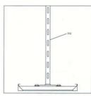
A 1940, T 76 Tij ile birlikte kullanılarak da kablo kanalı askılanabilir. Can be used in with a Teege.
