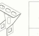
Tavan bağlantısı T 31 beton duvara çelik dübel ile monte edilir.
