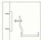
Dahili Dirsek Kolu D 17, T somun kullanılarak Montaj Rayı T 40 üzerine monte edilebilir. D17 can be mounted on a mounting rail by using T bolt.
