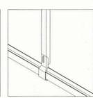
Aydınlatma kanalı Askı Braketi T 81 ve T 32 kullanılarak askılanabilir.
