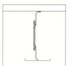
Tij T 76 uygun boyda kesilerek iki adet T 81 ile birlikte kablo kanalı montajında kullanılabilir. Can be cut into pieces whenever necessary.
