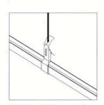
Aydınlatma kanallarının askılanmasında vidasız birleştirme olarak kullanılır. Can be used in mounting lighting trunking pendant.
